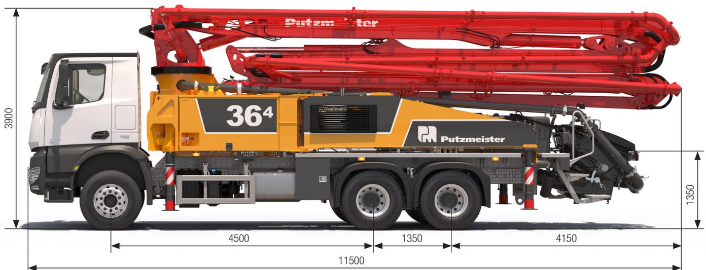
Nota: versione standard. Le dimensioni e il peso variano in base all'autocarro, al modello di pompa e all'attrezzatura.
