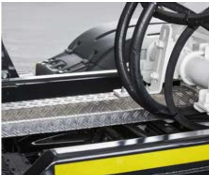
◀ Die flexible hochwertige Gelenkwel-lenabdeckung lässt sich im Wartungsfall schnell demontieren
