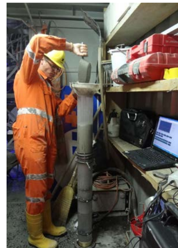
▲ Slipper Test zur Ermittlung der Pumpfähigkeit des Betons
