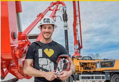
Ein weitere Komfortfunktion für Maschinisten: intelligent Boom Control (iBC). Dieses Feature erleichtert die Steuerung des Armpaketes noch einmal deutlich. Alle Arm-Bewegungen lassen sich über den Joystick mit nur einer Hand einfach und exakt erledigen. Dabei wurde das Ansprechverhalten im Vergleich zur Ergonic® 2 nochmals um 80 % verbessert.
