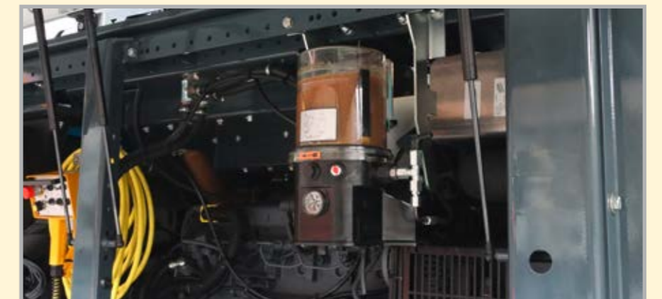
O sistema elétrica de lubrificação central poupa tempo de trabalho e minimiza o desgaste
