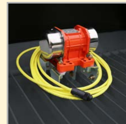
O vibrador auxilia o enchimento perfeito da bomba de betão
