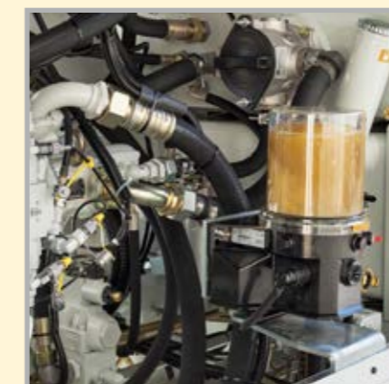
Die elektronische Fettzentralschmierung spart Arbeitszeit und minimiert Verschleiß
