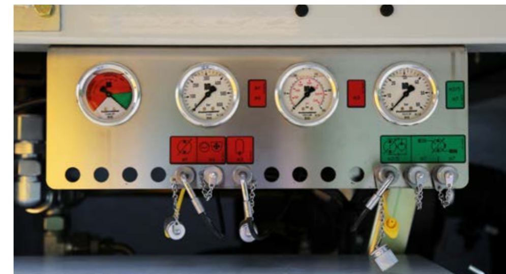
Mini-Messleiste: Alle hydraulischen Messpunkte sind an zentraler Stelle ablesbar (BSA neuester Generation)
