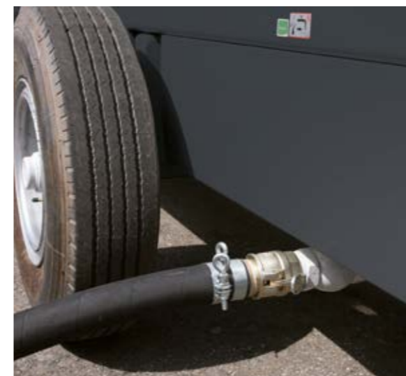
Frei zugänglicher Wasseranschluss
