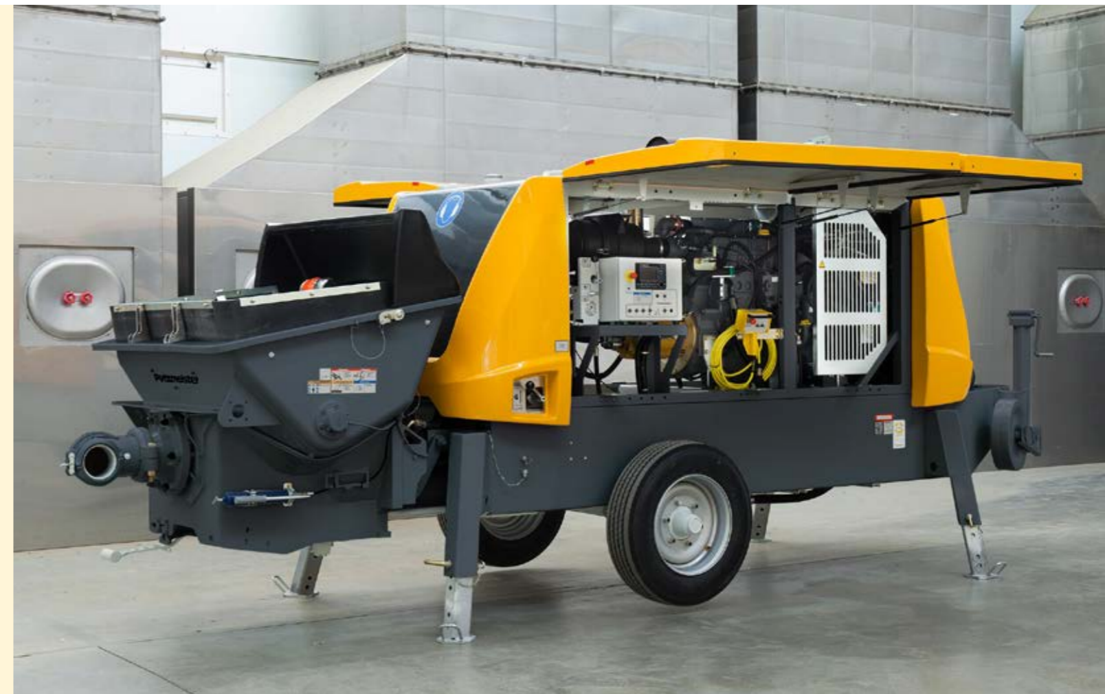
Schwenktüren sorgen für einen unkomplizierten Zugang und bieten bei Tätigkeiten am Inneren der Maschine Schutz vor Regen und Sonne
