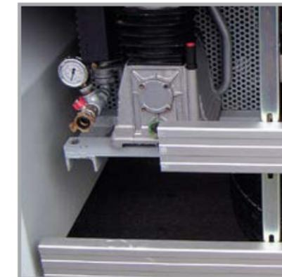
Compressor económico com 455 l/min e 12 bar de pressão – montado atrás da proteção inferior lateral graças às dimensões compactas
