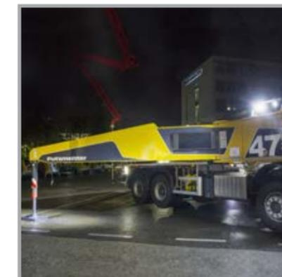
Projetores de iluminação dos 4 pontos de estabilização tornam a instalação mais segura e rápida na escuridão
