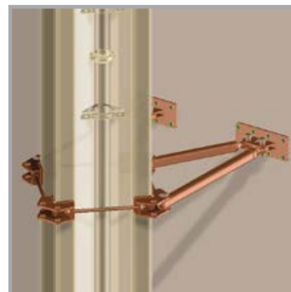
Anclaje en la estructura (5)
