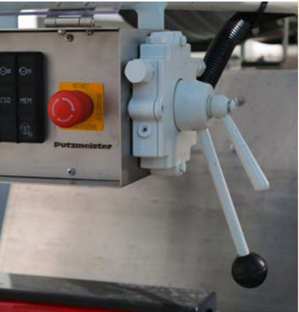
Levier de commande pour la vitesse du tambour et le sens de rotation
