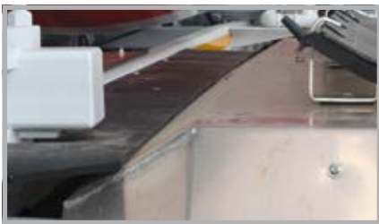
Protection contre les projections
