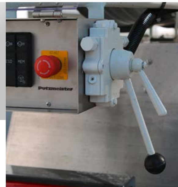
Bedienhebel für Trommelgeschwindigkeit und Drehrichtung
