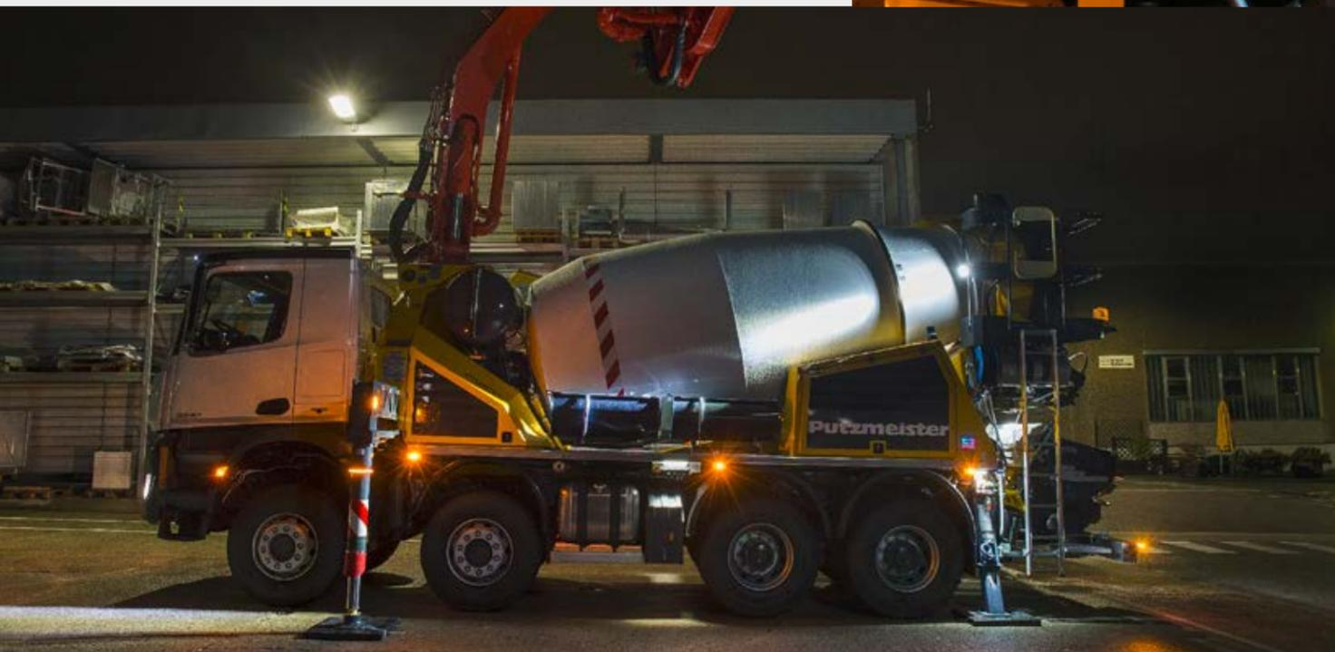
Le nouveau concept d'éclairage pour l'illumination des postes de commande et des zones de stabilisation est non seulement synonyme de confort, mais aussi de plus de sécurité dans l'environnement de la machine
