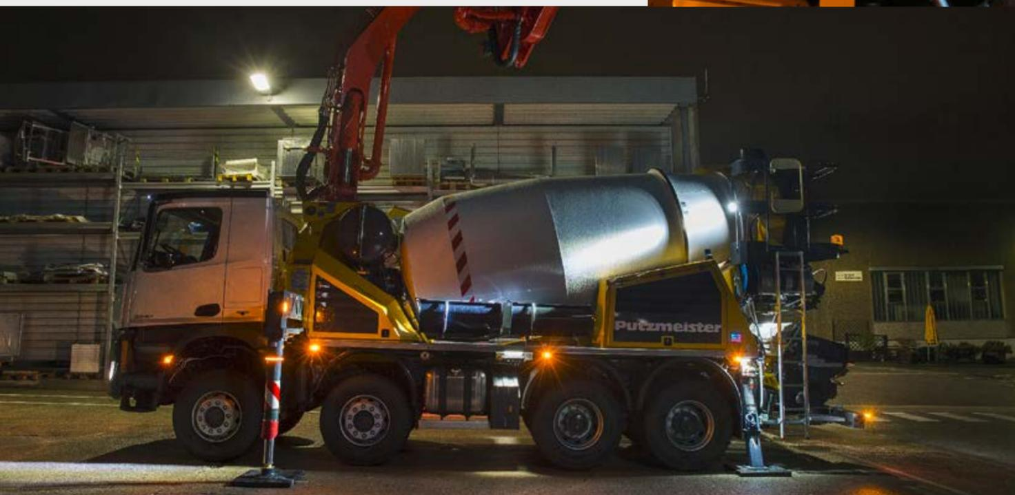
El nuevo concepto de luz para la iluminación de los puntos de mando y las zonas de apoyo no solo ofrece confort, sino además más seguridad en el entorno de la máquina
