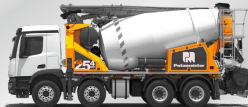
Der verwindungssteife Integralrahmen reduziert Verschleiß und Kosten und sorgt für einen stabilen Stand insbesondere beim Pumpen. Ideale Kraftableitung vom Mast in den Rahmen bzw. in die Abstützfüße.
