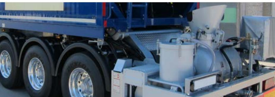
Chape traditionnelle – cuve de malaxage avec transporteur pneumatique (TransMix 5500)
