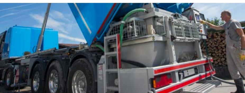
Chape autonivelante – malaxeur, trémie de pompage et pompe à vis (TransMix 3200)
