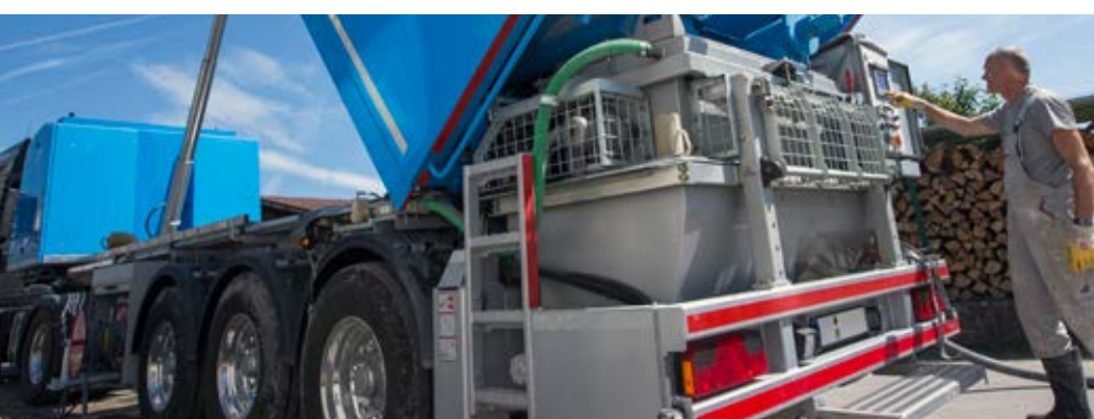
Gietvloeren – menger, pomptrechter en wormpomp (TransMix 3200)
