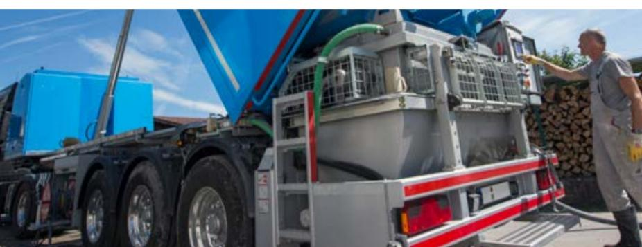
Betonilha líquida – Misturador, tremonha de bombagem e bomba de parafuso sem-fim (TransMix 3200)
