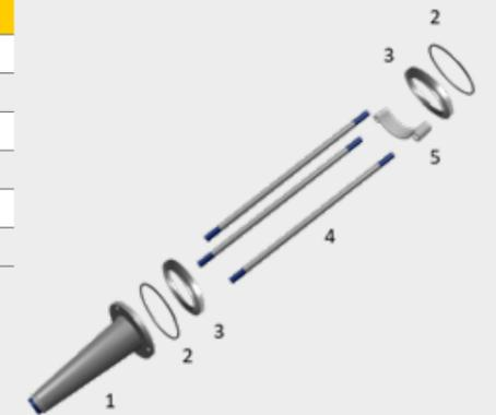
Verschleiß- und Ersatzteile Mischer-Pumpeinheit
