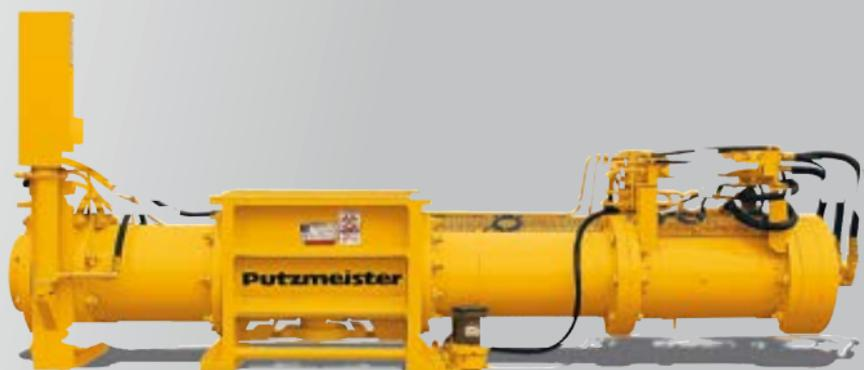
La série EKO est conçue pour accomplir des missions de pompage extrêmes. Le principe du gavage à chambre directe permet d'alimenter la pompe en produit extrêmement sec à forte teneur en corps étrangers. Le piston entraîné hydrauliquement pousse également des produits, jusqu'à là non pompables, dans la tuyauterie, tels que des boues de papeteries hautement déshydratées.
