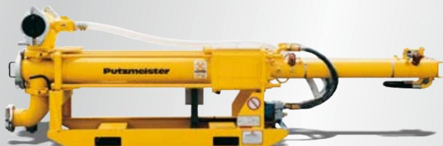
La série KOV se caractérise par sa conception simple et sa grande fiabilité. Les cylindres d'aspiration et de refoulement sont reliés par des boules à actionnement indirect.
