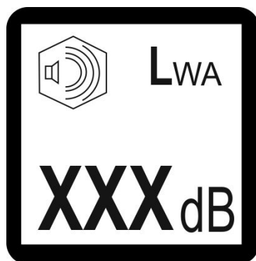
Figura 5: Plăcuța – nivelul puterii acustice
