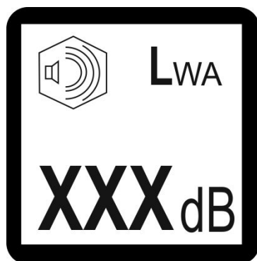
Figura 5: Targhetta – Livello di emissione acustica
