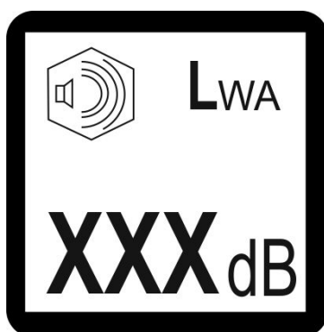
Ilustracja 5: Tablica – poziom mocy akustycznej
