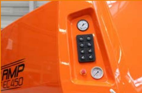
Panneau de commande dépouillé avec clavier simple et robuste et deux manomètres
