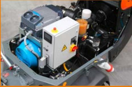
Compresseur puissant équipé d'un moteur électrique à fréquence régulée
