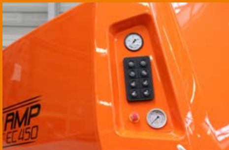
Schlichtes Bedienfeld mit einfachem, robustem Keypad und zwei Manometern
