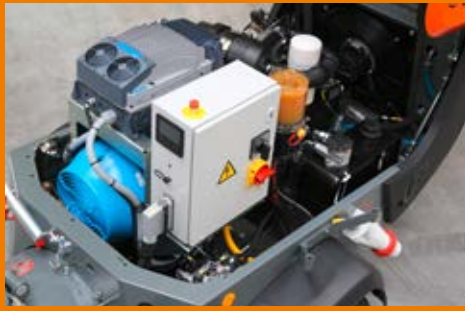
Leistungstarkes Kompressoraggregat mit frequenzgeregeltem Elektromotor
