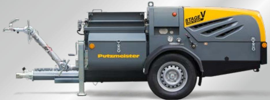
La SP 11 THF cumple con la norma de emisiones Stage V. Cubre fácilmente distancias de transporte de hasta 80 m de ancho o 30 m de alto. Para un flujo de material continuo, incluso en pavimentos con fibras sintéticas o metálicas, se han mejorado la criba y los vibradores. De esta forma, alcanza un caudal de hasta 15 m<sup>3</sup>/h y aporta todo lo que un solado fluido profesional necesita.
