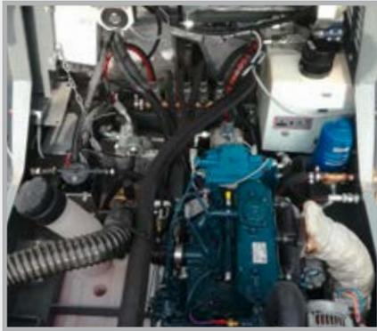
El motor diésel mecánico de 3 cilindros de Kubota cumple con la norma de gases de escape «Stage V» y es extremadamente eficiente y requiere poco mantenimiento, lo que conlleva unos gastos considerablemente menores de funcionamiento y mantenimiento.
