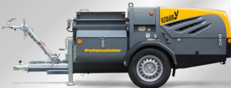
A SP 11 THF corresponde à norma sobre emissões de gases de escape Stage V. Esta transpõe distâncias de bombagem de até 80 m em largura ou 30 m em altura com facilidade. O crivo e o vibrador foram melhorados para um fluxo de material contínuo, mesmo no caso de betonilhas com fibras de plástico ou metal. Assim, atinge um débito de bombagem de até 15 m<sup>3</sup>/h e tem tudo o que é necessário para bombear betonilha líquida com profissionalismo.
