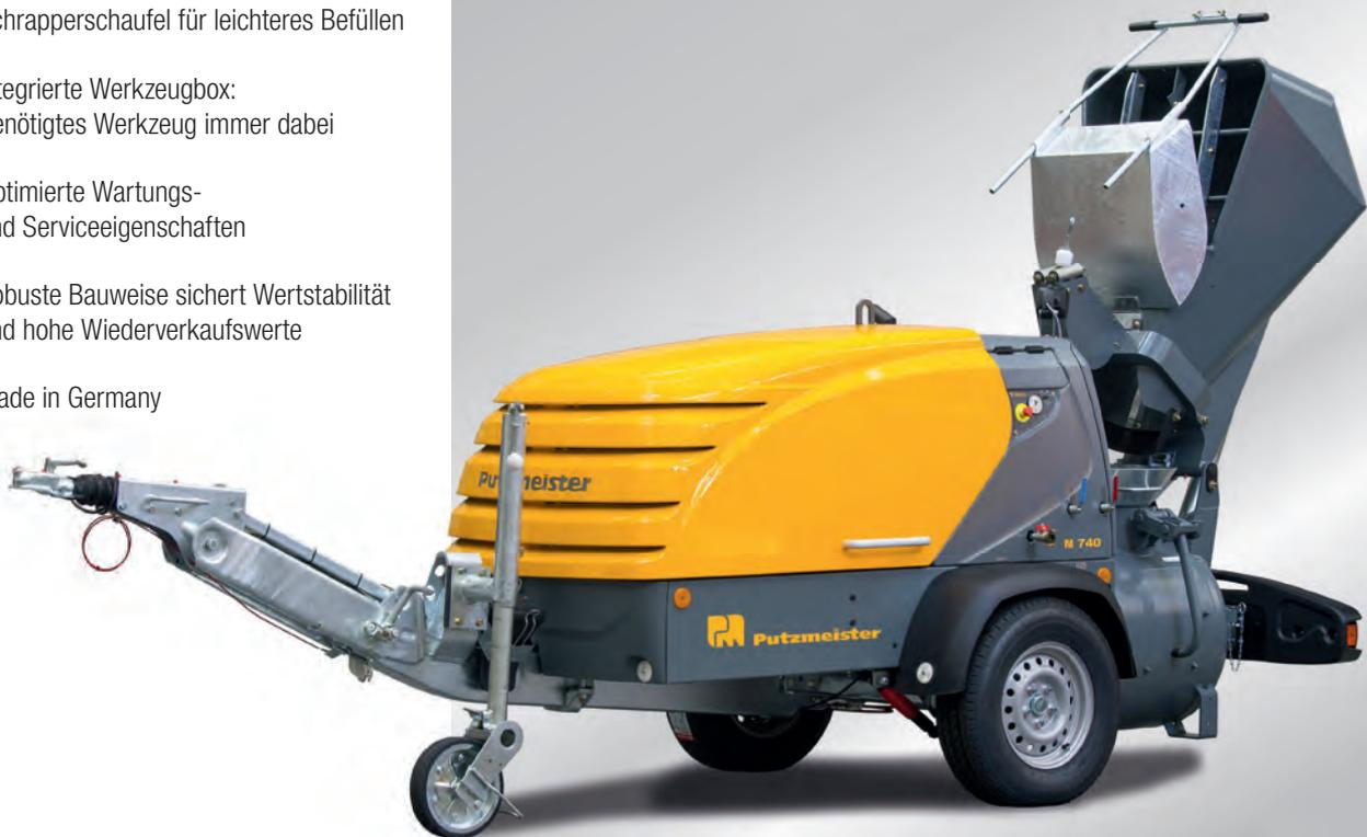
Die Mixokret M 740 ist mit einer leistungsstarken Antriebseinheit ausgestattet, die Kraftstoff spart und für ein schonenderes, gleichmäßigeres Pumpverhalten sorgt. Das bedeutet konstanten Materialfluss und weniger Schläge in den Schlauchleitungen.
