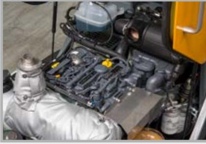
Maximale Antriebsleistung dank des 44,5 kW Deutz-Motors – dieser erfüllt alle Anforderungen des gültigen Emissionsstandards „Stage V“
