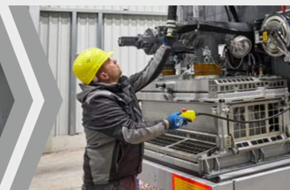
Le déroulement et l'enroulement du tuyau de pompe s'effectuent à l'aide de la télécommande
