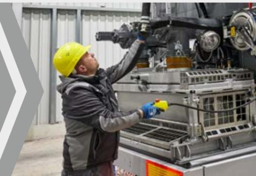
Sowohl das Ausrollen und auch Einrollen der Förderleitung erfolgt über die Fernbedienung
