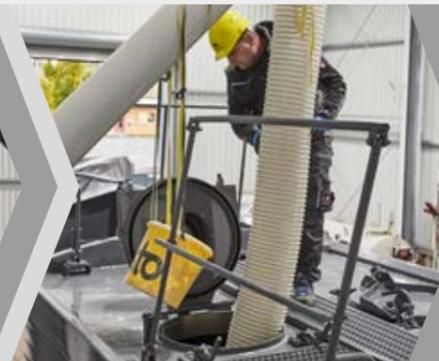
Befüllen der Binderkammer
