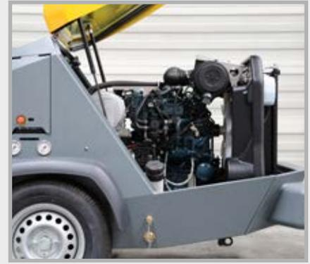
Der leistungsstarke, turboaufgeladene Dieselmotor mit 37 kW und Dieselpartikelfilter erfüllt die Abgasstufe „Stage V“. Damit kann die Pumpe problemlos in der EU sowie in der Schweiz betrieben werden.
