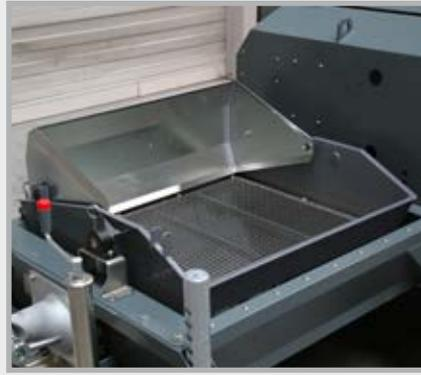
Fördertrichter mit 250 l Volumen, vergrößertem Einfüllbereich und schwenkbarem Spritzschutz – serienmäßig mit leistungsstarkem Rüttler. Niedrigere Einfüllhöhe vereinfacht Endreinigung und Beschickung durch Fahrmiter.
