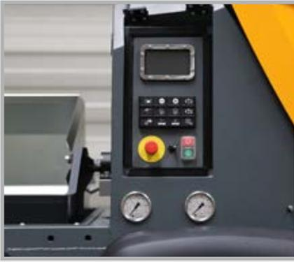
Das zentrale Bedienfeld mit intuitivem Keypad erhöht die Bediensicherheit. Ein übersichtliches Display hinter kratzfestem Schutzglas versorgt den Anwender mit allen relevanten Informationen.
