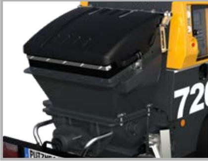
Großer, klappbarer Trichter mit Gummikragen (280 l), Schutzgrill und Splash Guard (optional) – perfekter Schutz vor Betonspritzern.
