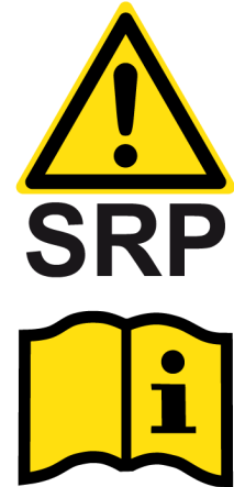
Ilustracja 1: Oznakowanie elementów bezpieczeństwa (SRP)
