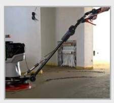
Perfekte Ergonomie dank stufenlos verstellbarer Deichsel. Ermüdungsarmes Arbeiten durch Betätigung des Schalters mit der ganzen Hand.
