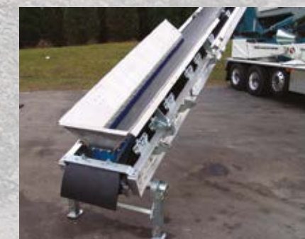
Seitliche Beladungswändetrichter 2,45 m x 0,76 m (optional)
