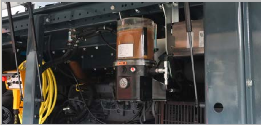
La centrale de graissage électrique fait économiser du temps de travail et diminue l'usure
