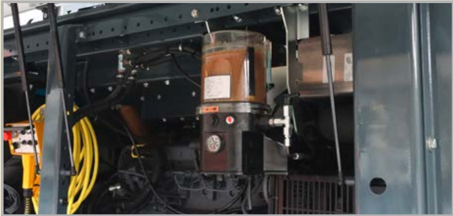
O sistema elétrica de lubrificação central poupa tempo de trabalho e minimiza o desgaste
