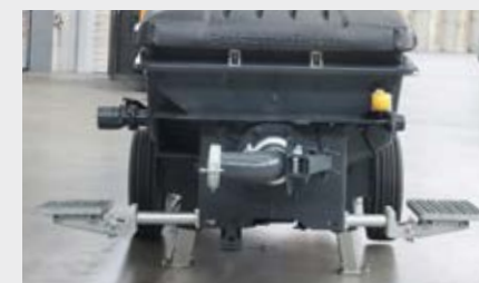
Accesos laterales a la tolva
