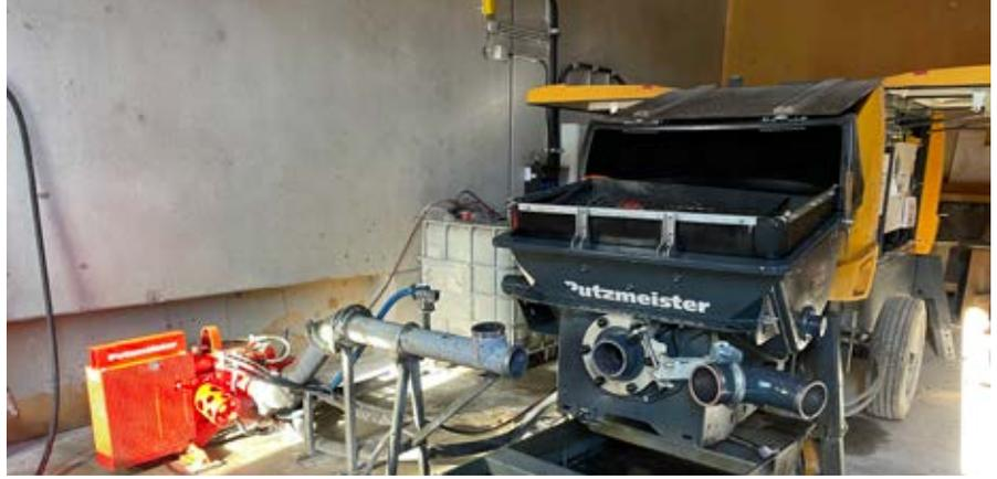
Pompe à béton stationnaire BSA 1408 E avec vanne d'arrêt, coude rabattable et raccord en T pour faciliter le nettoyage, bac de nettoyage pour nettoyer la trémie
