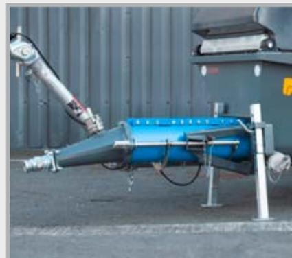
Le système breveté de changement rapide de la pompe à vis sans fin permet de gagner du temps et facilite les manipulations. Une seule personne suffit pour changer la combinaison rotor/stator 2L8, même la plus lourde, sans aucun outil supplémentaire.
