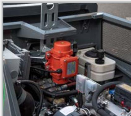
Le nouveau vibreur « ICC » est situé à l'extérieur de la zone exposée aux saletés sous le capot. Le chargeur de batterie optionnel pour la télécommande sans fil avec réglage précis du débit se trouve également à cet endroit.
