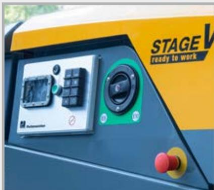
Le panneau de commande équipé d'un clavier ergonomique accroît la sécurité des opérations. L'utilisateur dispose de toutes les informations utiles sur un écran simple situé derrière un verre résistant aux rayures.
