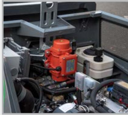
Der neue „ICC“-Rüttler befindet sich außerhalb des Schmutzbereichs unter der Haube. Hier befindet sich auch das optionale Akkuladegerät für die Funkfernsteuerung mit präziser Fördermengen-einstellung.
