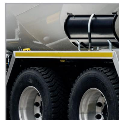
Gain de temps et sécurité totale, grâce à des éléments de sécurité faciles à monter, comme la bande réfléchissante adhésive sur les ailes en aluminium à la forme revue et corrigée.
