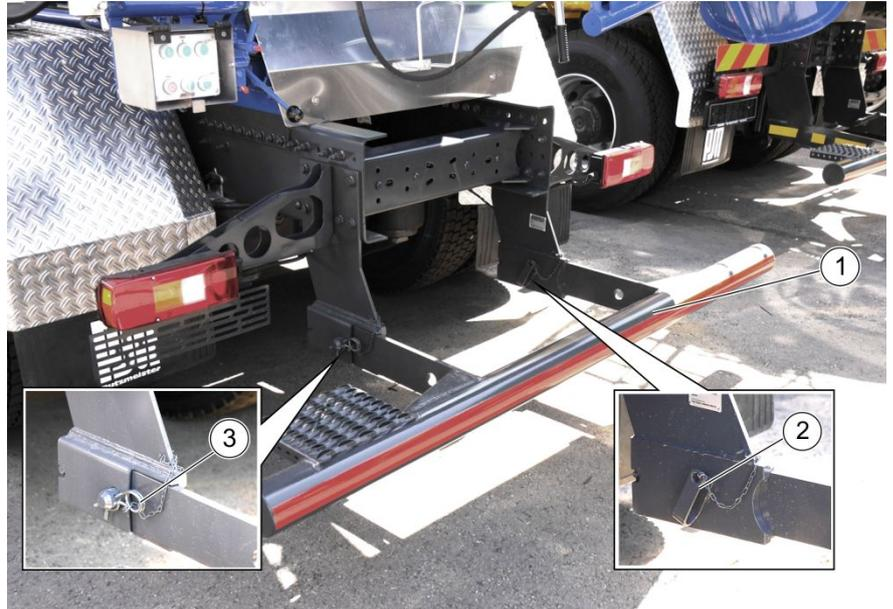
**Abbildung 32: schiebbarer Unterfahrerschutz**
