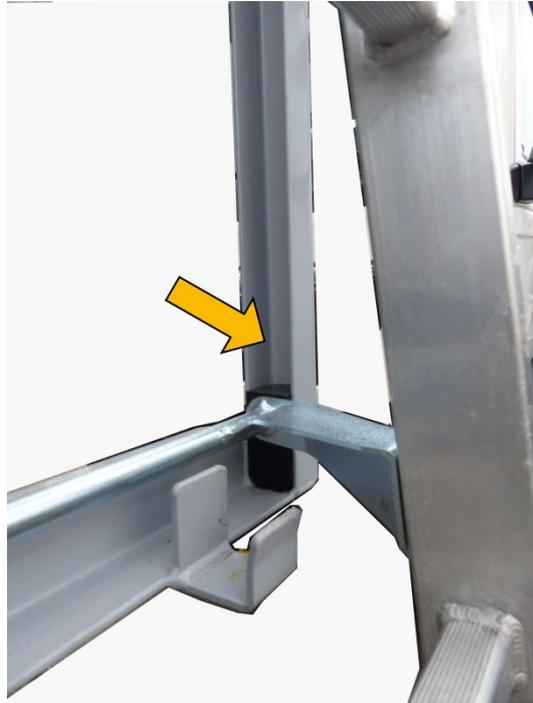
Abbildung 70: Schmierstellen an der Leiterführung
