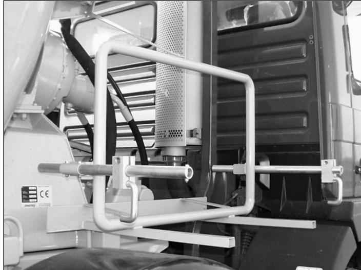
**Abbildung 23: Mörtelkübelhalterung**
