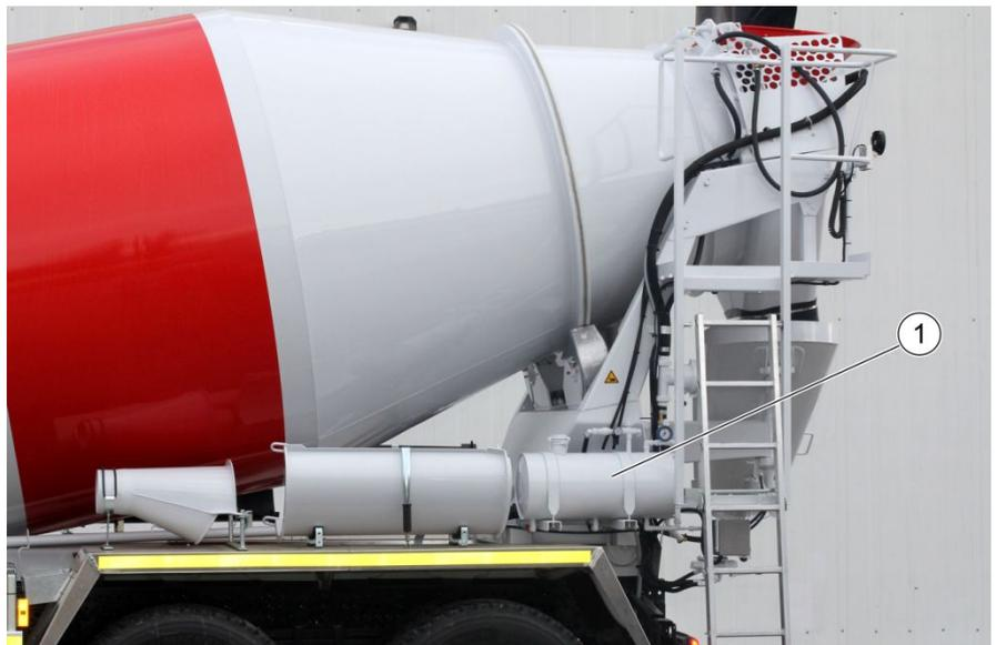
Abbildung 29: Pneumatischer Zusatzmittelbehälter
