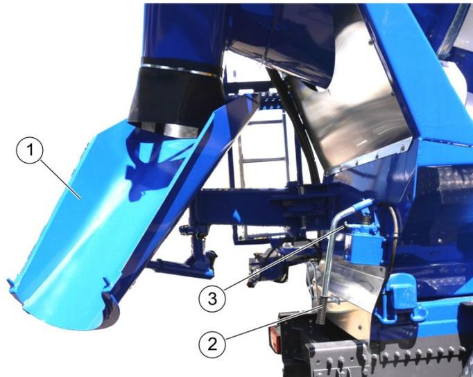
Abbildung 12: Handpumpe zum Verstellen der Schwenkschurre
