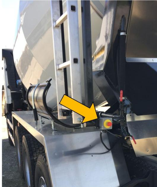
Abbildung 10: NOT-HALT Taster am Heck
