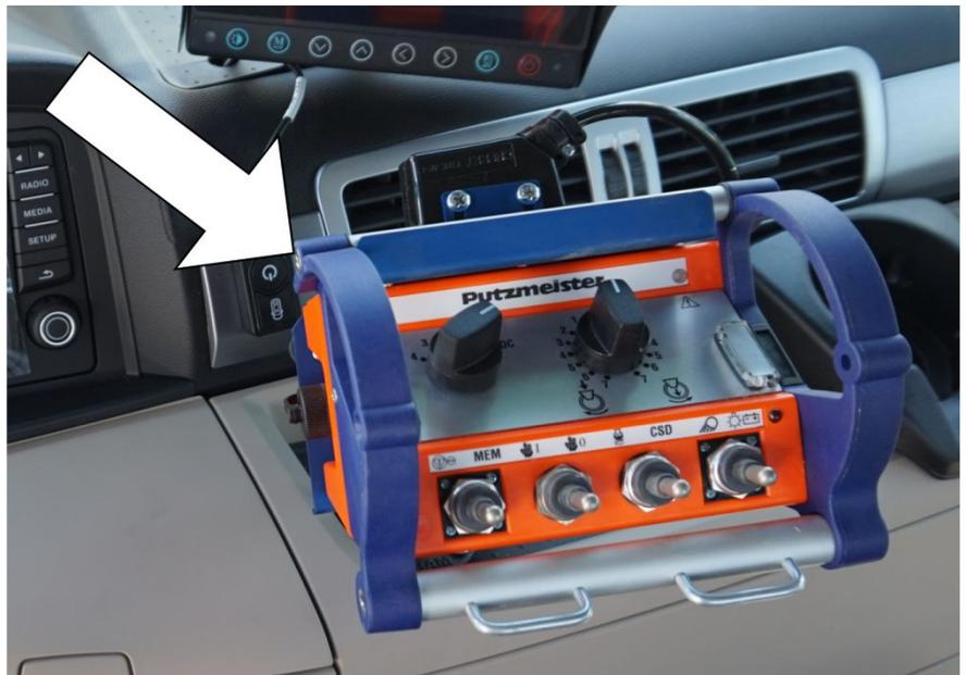
**Abbildung 8: Funkfernsteuerung mit Halterung**
