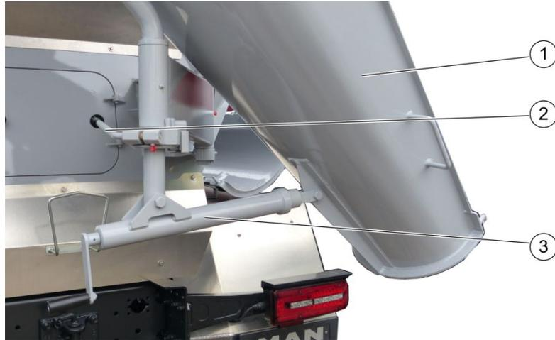
Abbildung 40: Schurrenstütze mit Handkurbel
