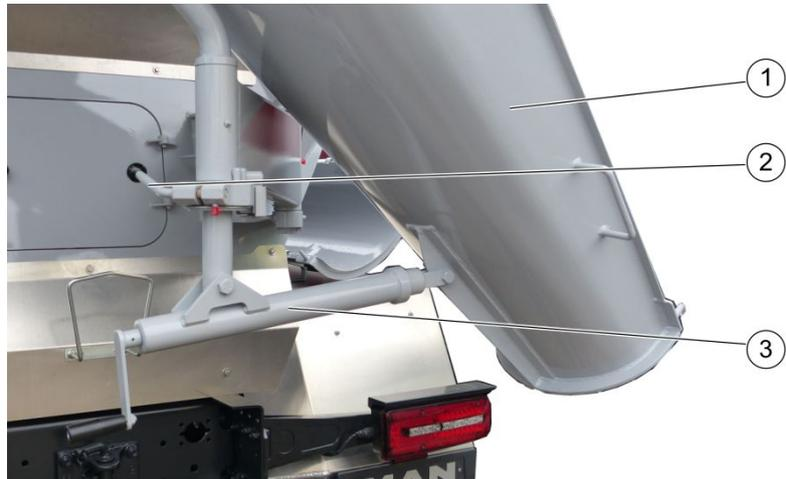
Abbildung 11: Schurrenstütze mit Handkurbel
