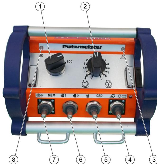
Abbildung 43: Funkfernsteuerung
