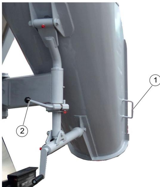
Abbildung 61: Schwenkschurre prüfen
