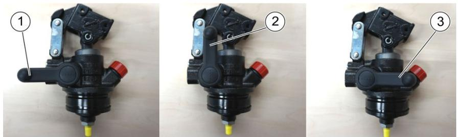
Abbildung 15: Richtungshebel an Handpumpe
