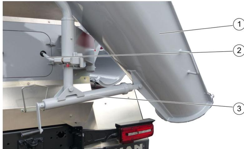
Abbildung 12: Schurrenstütze mit Handkurbel
