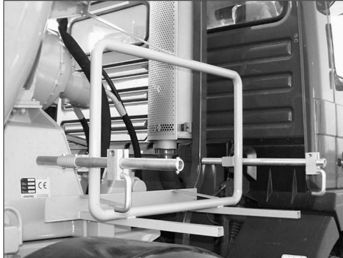
**Abbildung 24: Mörtelkübelhalterung**
