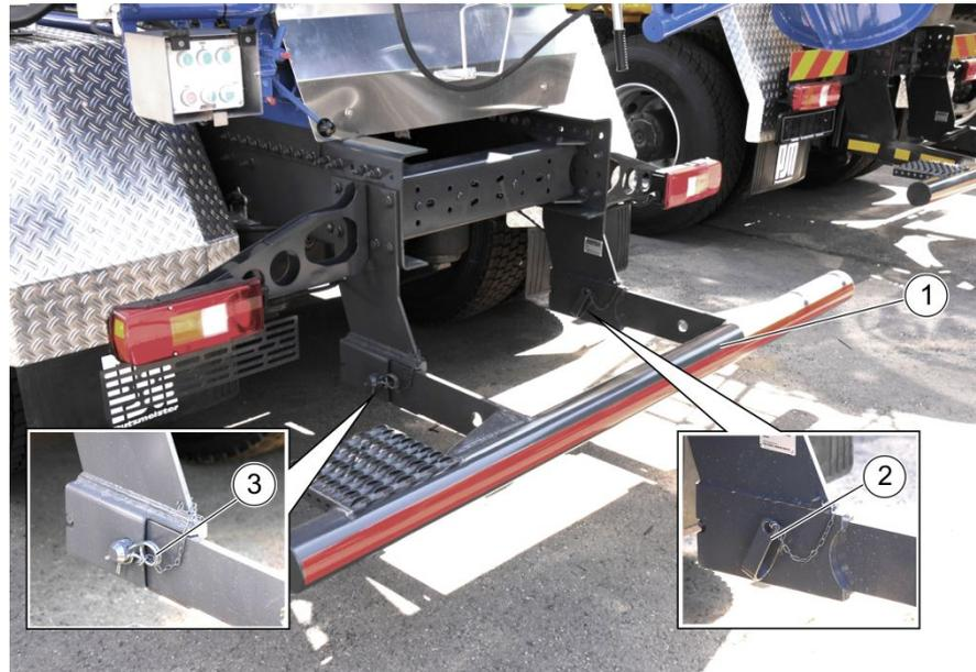
**Abbildung 33: schiebbarer Unterfahrschutz**
