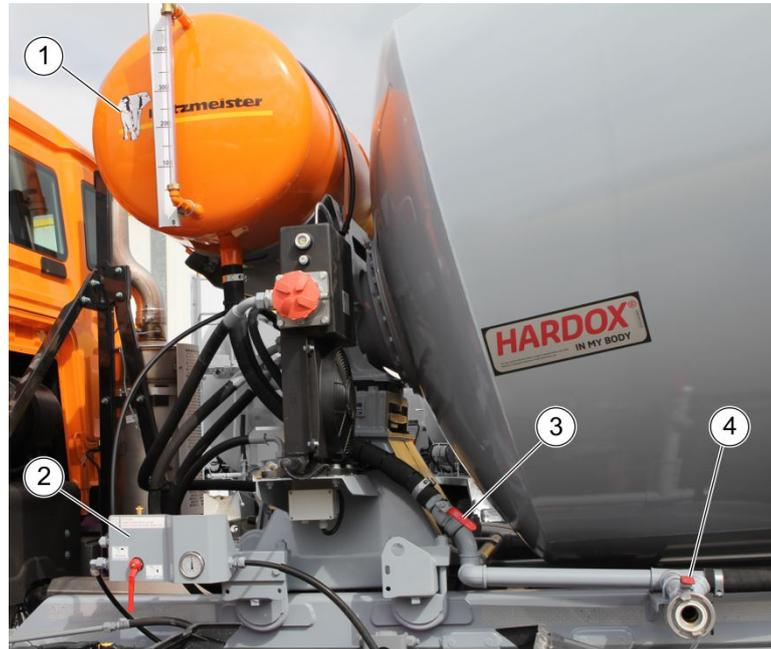
Abbildung 20: Druckwassersystem
