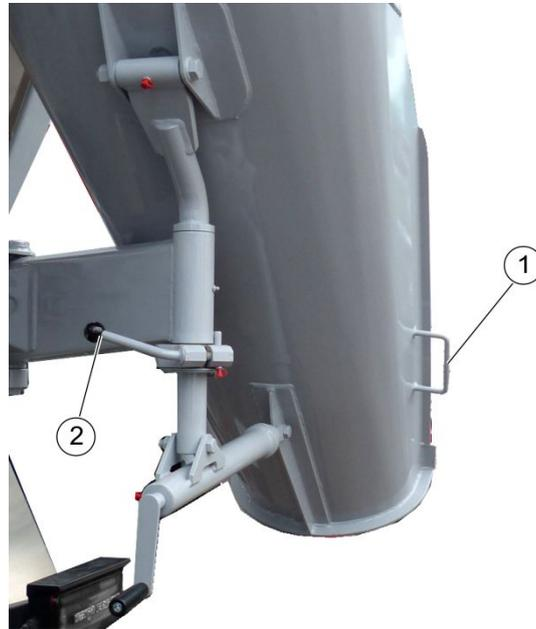
Abbildung 65: Schwenkschurre prüfen
