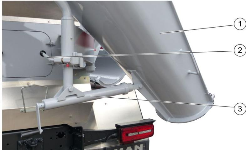
Abbildung 41: Schurrenstütze mit Handkurbel
