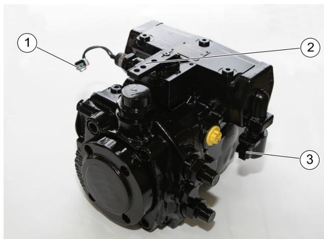
Abbildung 48: Hydraulikpumpe
