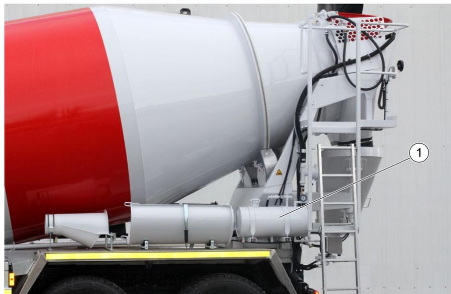
Abbildung 30: Pneumatischer Zusatzmittelbehälter
