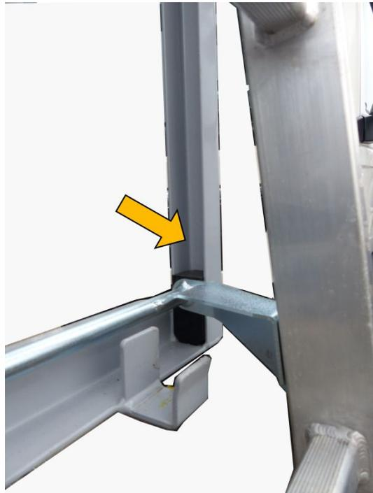
Abbildung 74: Schmierstellen an der Leiterführung
