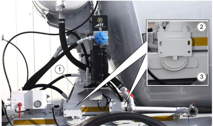
Abbildung 54: Briden am Getriebestützbock
