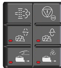
Figura 68: Avertizare: defecțiune detectată – Reacție necesară
