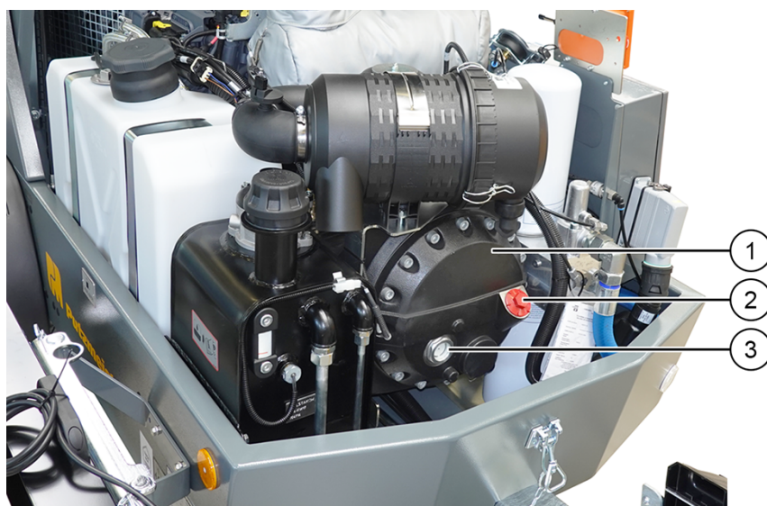
Figura 73: Vizor pentru uleiul de compresor
