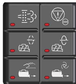
Figura 69: Avertizare: defecțiune detectată – Motorul de acționare oprit, funcționarea este întreruptă
