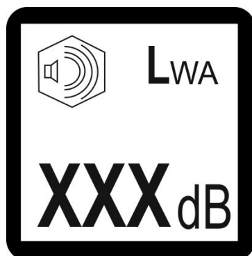
Ilustracja 6: Tablica – poziom mocy akustycznej
