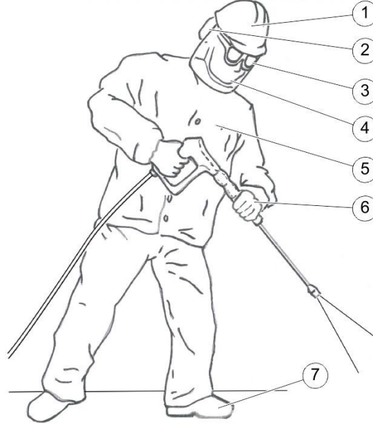
Şekil 1: Yüksek basınçlı sudan korunmak için kişisel iş güvenliği donanımı
