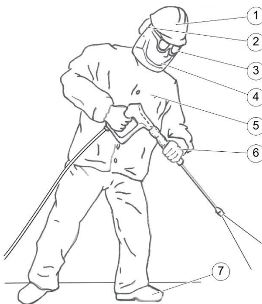
Figura 1: Echipamentul de protecție pentru lucrările cu jeturi de înaltă presiune
