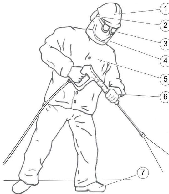
Abbildung 1: Schutzausrüstung für Hochdruckwasserstrahlarbeiten
