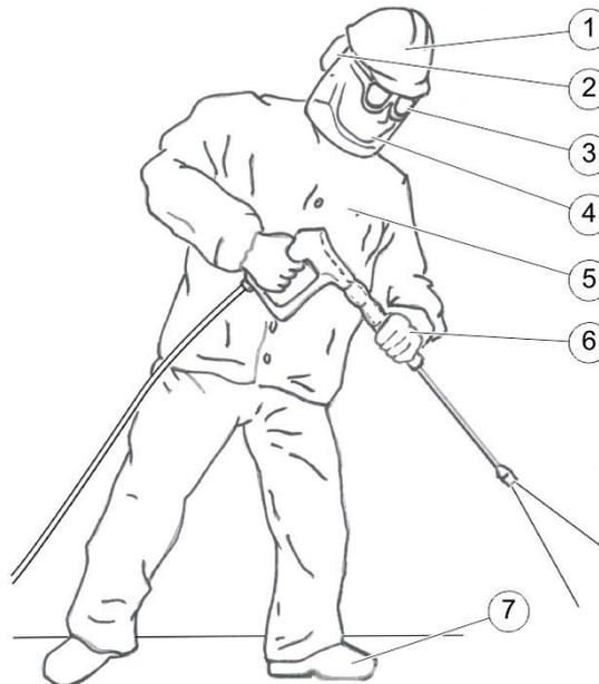
**Figura 1: Equipo de protección personal para trabajos con chorros de agua a alta presión**
