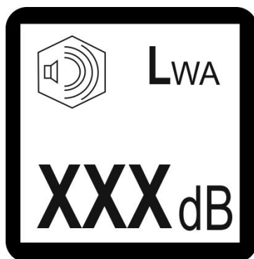
Ilustracja 8: Tablica – poziom mocy akustycznej
