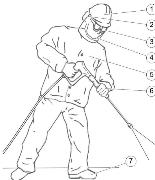
Рисунок 1: Защитное снаряжение для проведения работ с водой под высоким давлением
